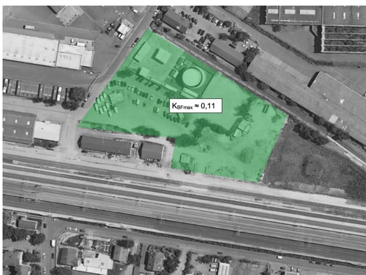
Abbildung aus dem Erschütterungsschutzgutachten des IB Sorge, aus dem hervorgeht, dass voraussichtlich die Anhaltswerte gem. DIN 4150-2 im gesamten Untersuchungsbereich eingehalten werden können.
